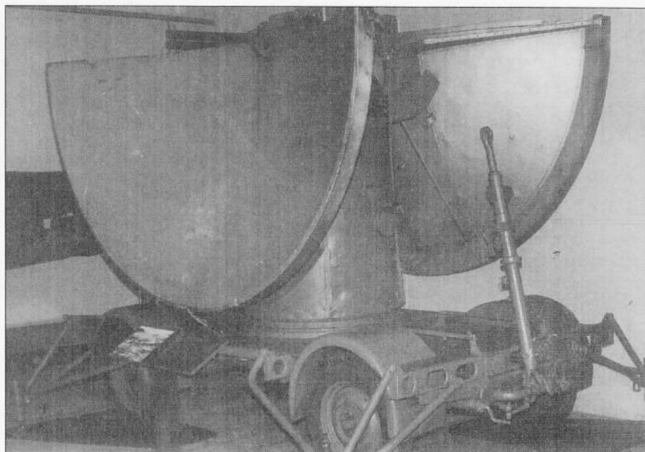
De opklapbare schotel van de Würzburg-radar.
